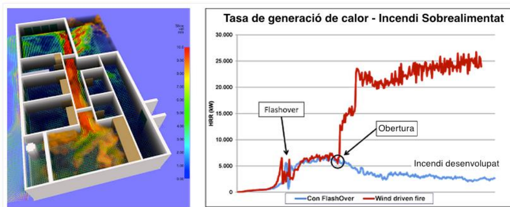
Fig.5. Salt de potència en un incendi sobrealimentat obtingut mitjançant simulació d'incendis.
