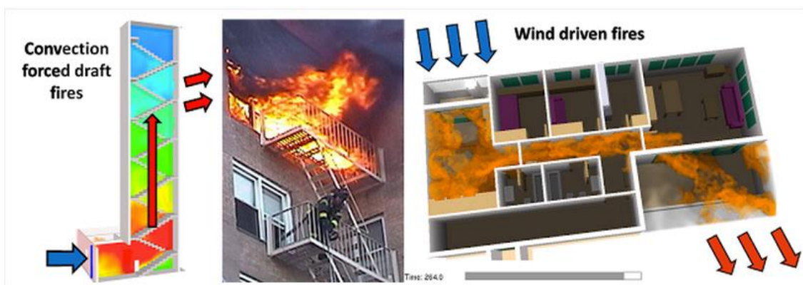
Fig.3. Efectes que desencadenen un incendi sobrealimentat
