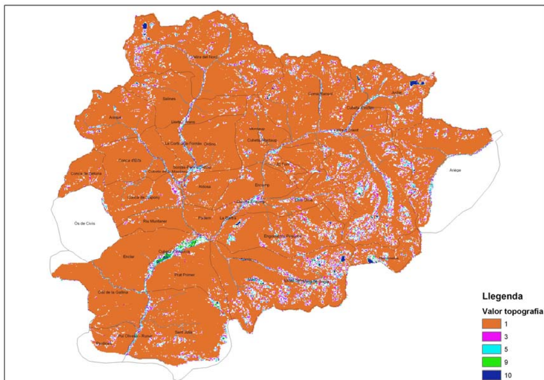
Figura 7. Mapa del valor assignat a cada cel·la del ràster en el càlcul de l'Índex DRASTIC pel pendent.
