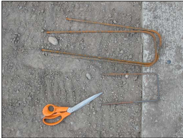
Fotografia 10.- Forma i dimensions de grapes utilitzades per a la fixació de geomalles i mantes orgàniques
