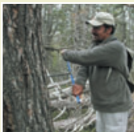
Fixació de la barrina de Pressler.
